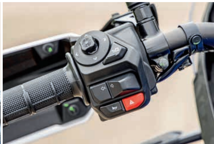
Nieuwe, verlichte knoppeneenheid met vierweschakelaar en een eigenlijk logische richtingaanwijzerbediening, die echter toch gewenning vraagt.
