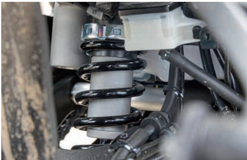
De nieuwe vering voelt veel stugger aan. Maar nog steeds is alleen de veervoorspanning achter verstelbaar.
