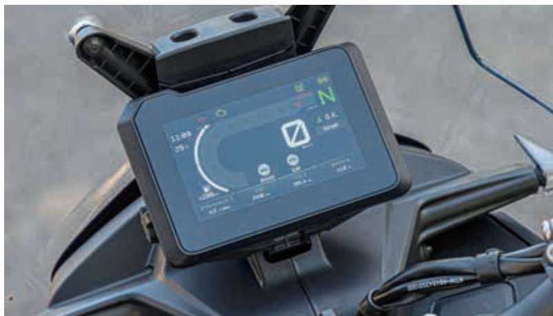
Het al vaak geprezen dashboard van de KTM, met een 5-inch TFT-scherm. Veel informatie die op overzichtelijke en intuïtieve wijze wordt weergegeven.
