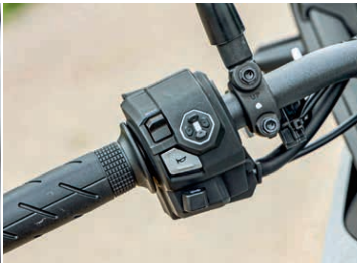
Nieuwe knoppenwinkel met minuscule, verlichte vierweschakelaar. Met dikke handschoenen aan is de bediening een beetje lastig.
