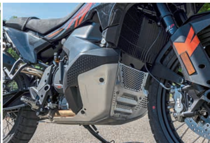
Naast de extreem ver naar onderen doorlopende tankwangen valt bij de KTM ook de grootste carterbeschermp plaat van dit kwartet op, die overigens standaard wordt gemonteerd.
