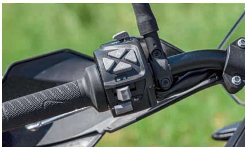
Kan bijna niet beter: de degelijke, verlichte vierwegschakelaar en logische menustructuur vergemakkelijken het navigeren door de vele menu's.
