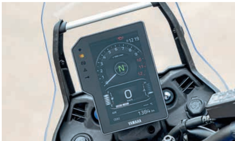
De Yamaha Ténéré 700 kreeg opnieuw een gemodificeerd TFT-dash-board, nu ook met diverse rijmodi, tractiecontrole, connectivity en nog veel meer.
