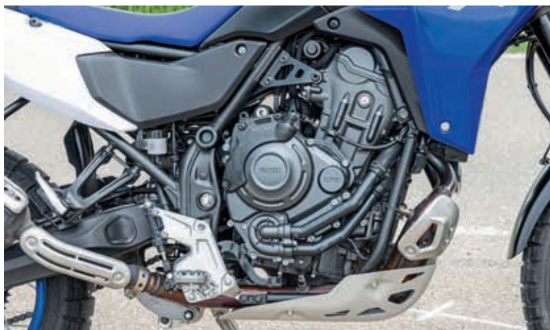
De bekende en beproefde parallel-twin met 270°-krukas bleef ongewijzigd. Inclusief de dit keer erg hakerig schakelende versnellingsbak.
