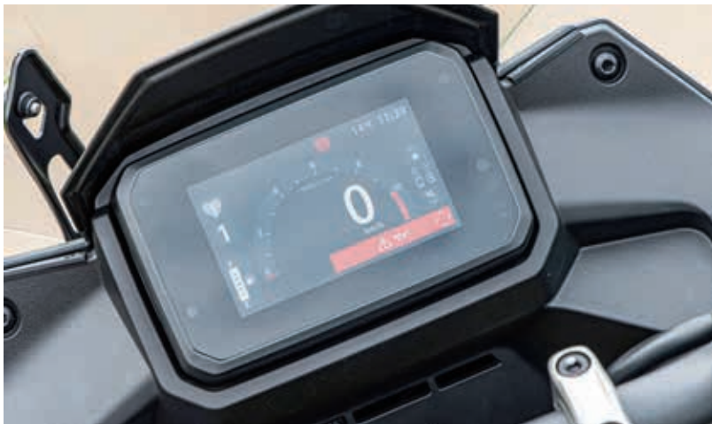
Het 5-inch TFT-dashboard werd qua lay-out en informatieverstrekking licht gemodificeerd. Nieuw is de buitentemperatuurgave.
